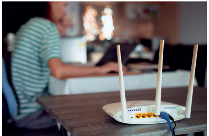
O roteador recebe o sinal do modem via cabo Ethernet e o distribui pelos dispositivos da rede local via wi-fi . Foto de 2021.
