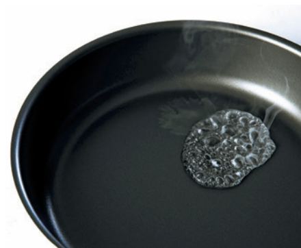
Gota de água em calefação no interior de uma frigideira quente.
