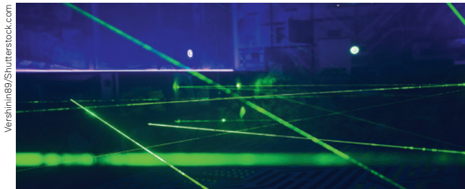
Lasers acionados em uma sala escura. Caso algum deles seja atravessado por algum corpo opaco, ativa-se um alarme.
