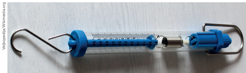
Este modelo de dinamômetro mede a força de tração em função da deformação de uma mola presa a um ponteiro, que indica o valor em uma escala.
