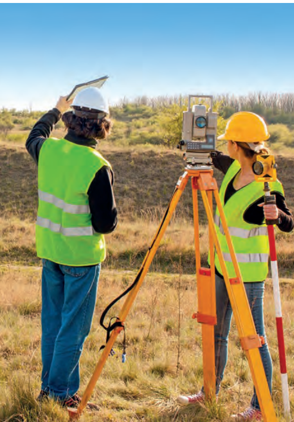
Profissionais trabalham na medição de terreno com uso de teodolito eletrônico, equipado com GPS. Sem local, sem data.
