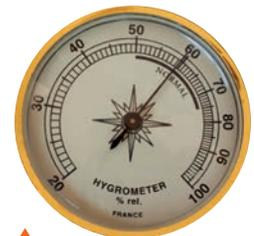
O higrômetro é o instrumento utilizado para medir a quantidade de vapor de água presente na atmosfera e expressa o resultado em porcentagem, ou seja, mede a umidade relativa do ar. O aparelho da fotografia registra 60% de umidade relativa; o ponto de saturação corresponderia a uma umidade relativa de 100%.
