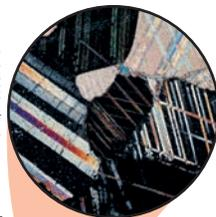
Foto com detalhes da composição do mármore, feita através do microscópio óptico.
