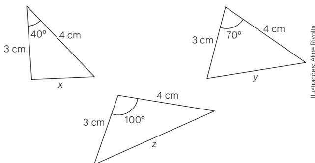
**a)** Utilizando a lei dos cossenos e uma calculadora, obtenham as medidas aproximadas dos lados indicados por  $x$ ,  $y$  e  $z$ . **28. a)  $x \cong 2,57$  cm;  $y \cong 4,10$  cm;  $z \cong 5,40$  cm**
