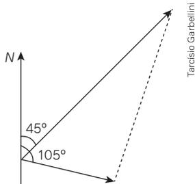
Calculamos o ângulo entre os vetores velocidade:  $a = 105^\circ - 45^\circ = 60^\circ$ .
