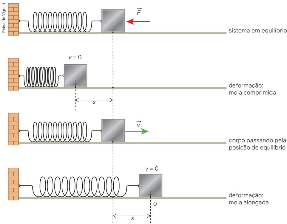
O corpo é retirado de sua posição de equilíbrio devido à atuação de uma força  $\vec{F}$  comprimindo a mola. A partir desse instante, ele é abandonado e começa a oscilar em torno de sua posição de equilíbrio em um MHS. A esse sistema damos o nome de oscilador harmônico.
