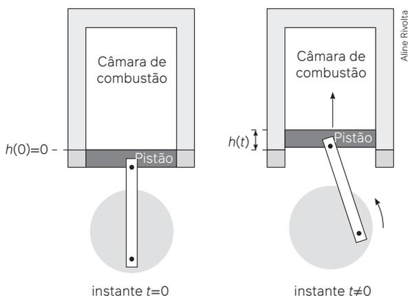
A função  $h(t) = 4 + 4\text{sen}\left(\frac{\beta t}{2} - \frac{\pi}{2}\right)$  definida para  $t \geq 0$  descreve como varia a altura  $h$ , medida em centímetro, da parte superior do pistão dentro da câmara de combustão, em função do tempo  $t$ , medido em segundo. Nas figuras estão indicadas as alturas do pistão em dois instantes distintos. O valor do parâmetro  $b$ , que é dado por um número inteiro positivo, está relacionado com a velocidade de deslocamento
