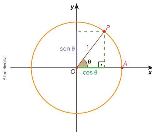
Interpretando dessa forma, podemos considerar que, para qualquer ponto da circunferência trigonométrica correspondente à extremidade de um arco, o cosseno e o seno são obtidos projetando-se ortogonalmente a extremidade desse arco no eixo  $x$  (**o cosseno será uma abscissa**) e no eixo  $y$  (**o seno será uma ordenada**), respectivamente.
