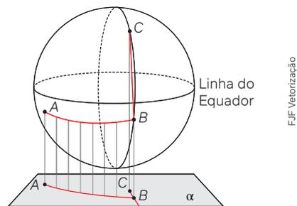
Pela figura podemos ver que o arco  $AB$  da superfície da Terra pertence a um plano paralelo a  $\alpha$ ; logo, sua projeção ortogonal em  $\alpha$  também será um arco. Notemos que os pontos  $B$  e  $C$  não são simétricos em relação à linha do equador, e o arco  $BC$  pertence a um plano perpendicular a  $\alpha$ ; logo, sua projeção ortogonal sobre  $\alpha$  será um segmento de reta. Portanto, o caminho traçado no globo pode ser representado pela alternativa **e**.
