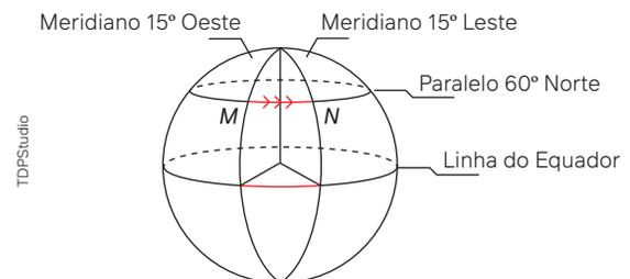
Considerando a Terra uma esfera de raio 6 400 km e adotando  $\pi = 3$ , para ir do ponto  $M$  ao ponto  $N$ , pela superfície da Terra no sentido indicado pelas setas vermelhas, a distância percorrida sobre o paralelo 60° Norte será igual a 37. Alternativa b.
