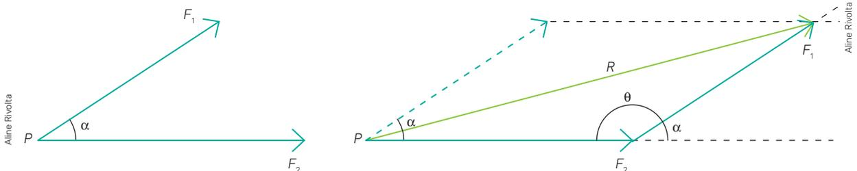
Sendo  $F_1$  e  $F_2$  os módulos das duas forças aplicadas em um corpo  $P$ , o módulo da resultante pode ser obtido pela relação matemática abaixo:
