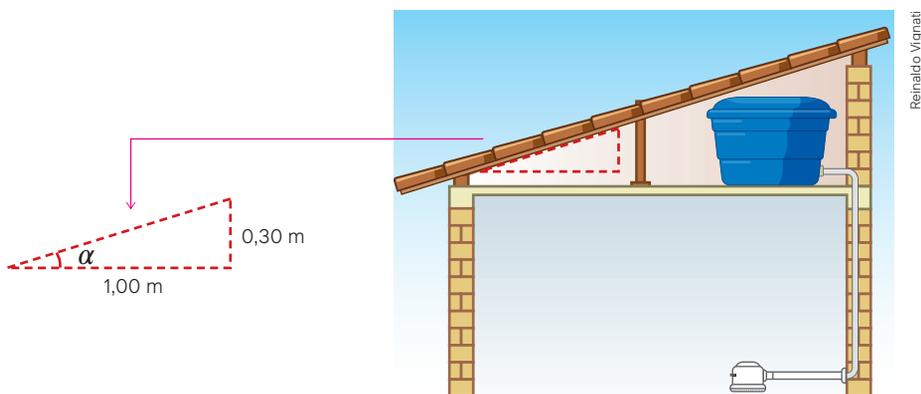
Utilizando uma calculadora, obtenha a medida do ângulo de inclinação do telhado representado na ilustração.
