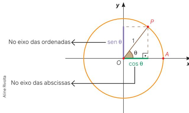
Veja que esse tipo de representação permite a determinação do seno e do cosseno de um ângulo a partir do ponto correspondente à extremidade do arco da seguinte maneira: projetamos ortogonalmente esse ponto no eixo das abscissas (x) e no eixo das ordenadas (y) para determinar, respectivamente, o cosseno (abscissa do ponto) e o seno (ordenada do ponto) do ângulo correspondente ao ponto.
