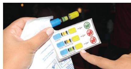
Etilômetro portátil. A mudança de coloração para verde nesses dispositivos indica a presença de etanol no teste.
