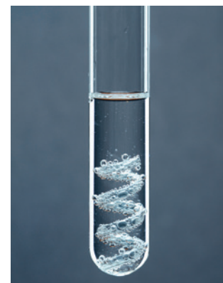
Amostra de zinco em um tubo de ensaio contendo solução de ácido clorídrico. O metal reage com os íons H + , provenientes da ionização do ácido, produzindo gás hidrogênio.
