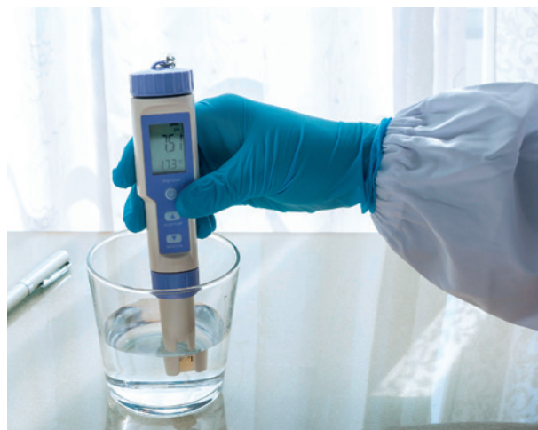
Os pHmetros são instrumentos digitais utilizados para a medição do pH de soluções.
