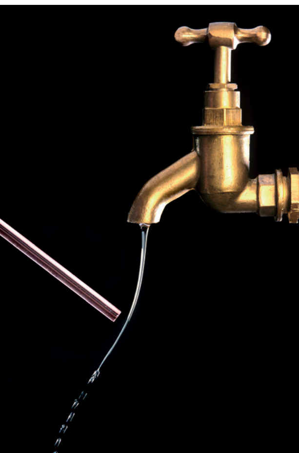
Fluxo de água de uma torneira sendo curvado por eletricidade estática. A água é atraída por um bastão de vidro com cargas elétricas.
