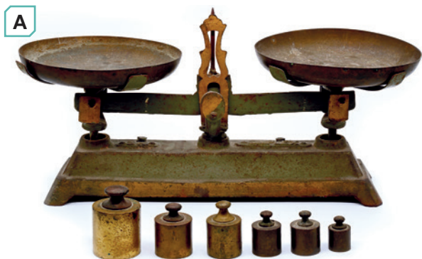
(A) Balança de pratos e peças de massa conhecida, chamadas de massas-padrão. (B) Balança digital para uso doméstico, por exemplo.
