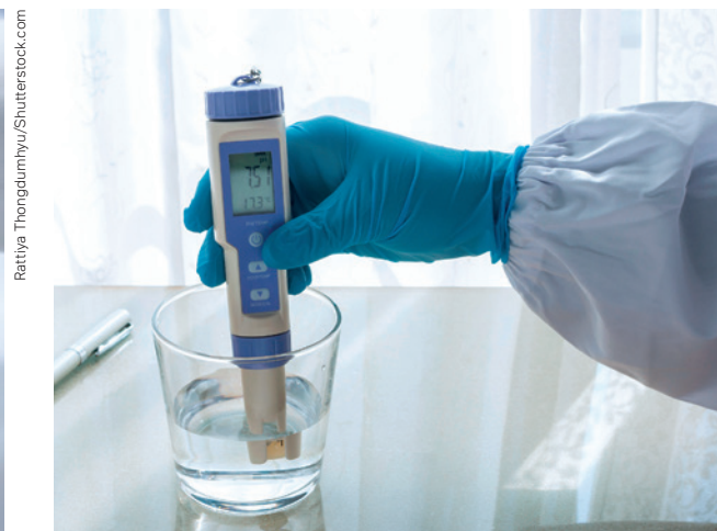
Os pHmetros são instrumentos digitais utilizados para a medição do pH de soluções.
