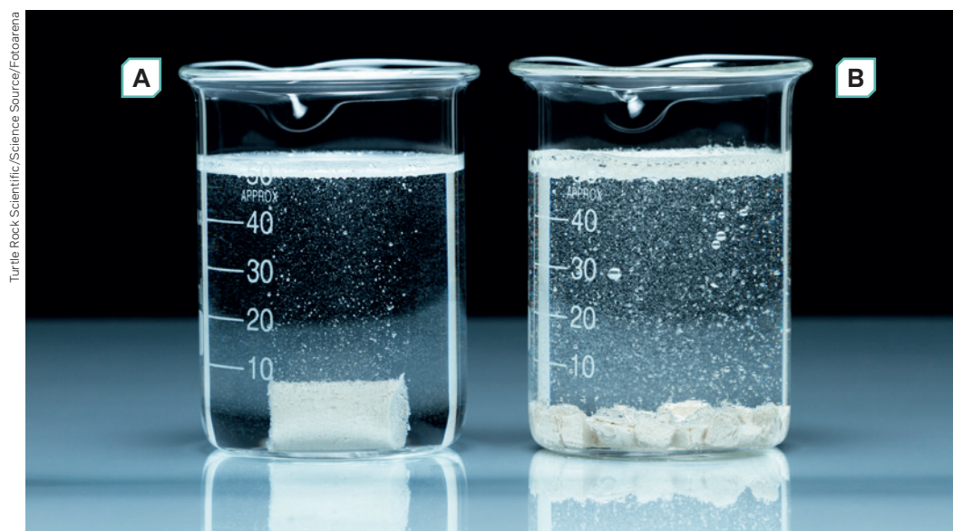
Béqueres com HCl(aq). No béquer (A), há um pedaço de giz na solução, e no béquer (B), a mesma porção de giz, porém, fragmentada.
