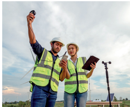
▲ Meteorologistas usando um anemômetro para medir a velocidade do vento, a temperatura e a umidade em um parque eólico.
