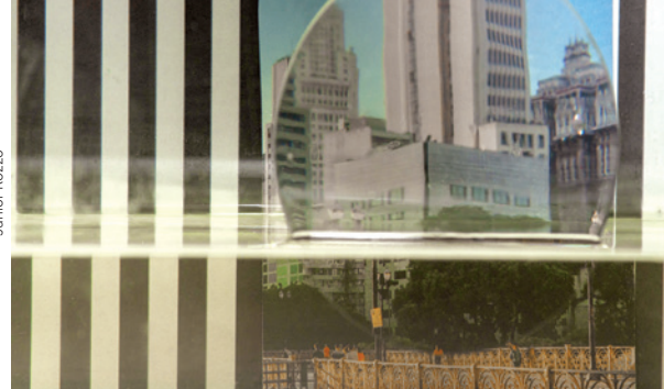
Exemplo de uma lente de vidro parcialmente no ar, desviando a luz, e parcialmente submersa em um líquido de mesmo índice de refração, não mais desviando a luz.
